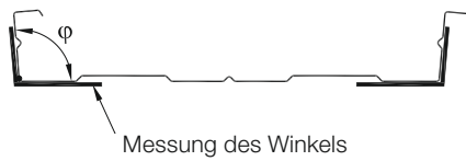
Abbildung 3.26: Messung des Eckwinkels Gurt/Steg
